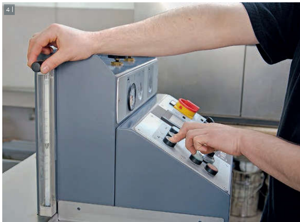
3 | Điều khiển bằng điện: Thiết bị cho phép đạt độ chính xác cao bởi thiết bị cho phép hiệu chỉnh lưu lượng bitum.
