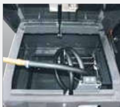
Bơm nạp nhiên liệu bằng điện
